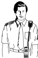
Figura 1: Colocación del RSM
