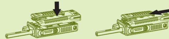
Entnehmen Sie den Akku der Schutzverpackung und legen Sie diesen in das Gerät ein. Achten Sie darauf das die Riegel auf der Rückseite des Gerätes, wie abgebildet, in den Akku greifen. Schieben sie den Akku vorsichtig nach oben bis die Verriegelung hörbar einrastet.
