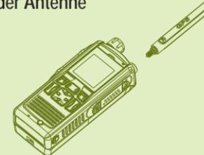
Die Antenne darf nur in ungefährlichen Bereichen angebracht werden. Schalten Sie das Funkgerät aus, bevor Sie die Antenne anbringen. Richten Sie die Antennenunterseite und die Gewindebasis an der Oberseite des Funkgeräts aus. Schrauben Sie die Antenne im Uhrzeigersinn bis zum Anschlag ein. Vermeiden Sie dabei ein Überdrehen.
