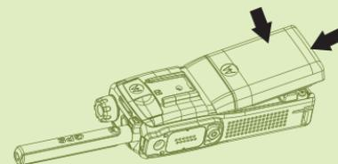
Nehmen Sie den Akku aus der weißen Papierschutzhülle. Legen Sie den Akku wie dargestellt mit der Oberseite in das Fach ein. Drücken Sie die Unterseite des Akkus nach unten, bis der Akku einrastet.
