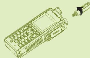
Schalten Sie das Funkgerät aus, bevor Sie die Antenne anbringen. Richten Sie die Antennenunterseite und die Gewindebasis an der Oberseite des Funkgeräts aus. Schrauben Sie die Antenne im Uhrzeigersinn bis zum Anschlag ein. Vermeiden Sie dabei ein Überdrehen.
