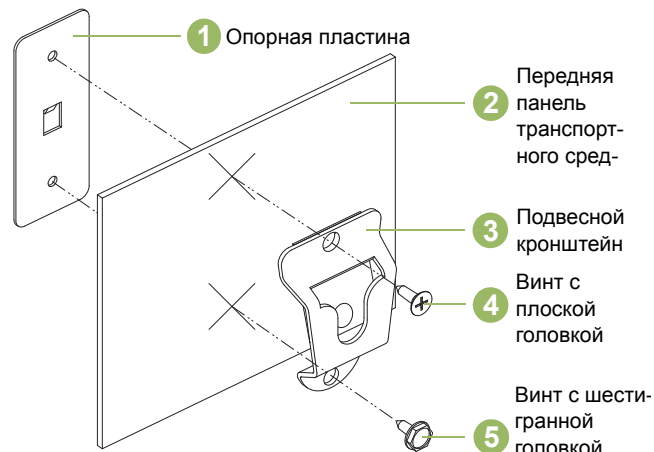
Рис. 3.1. Установка монтажного кронштейна
