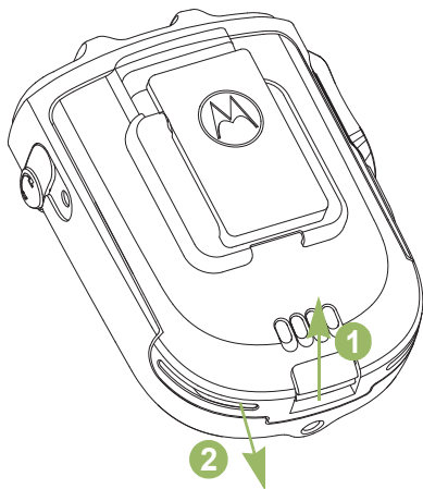
Figura 2.3: Extracción de la batería del WRSM
