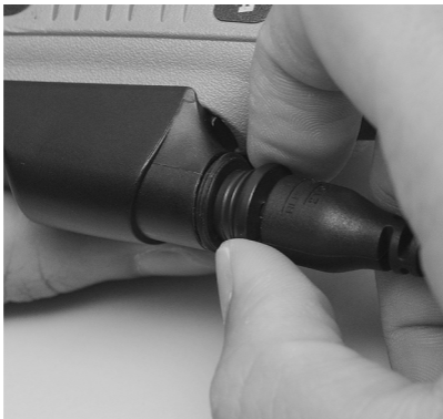
Figure 2. Pour retirer l'accessoire, tenez-le fermement (comme illustré dans la figure 2) et tirez.
