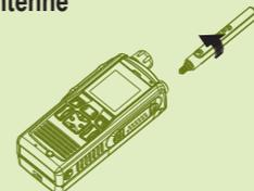
La fixation de l'antenne doit uniquement se faire dans des zones non dangereuses. Mettez le terminal hors tension avant de fixer l'antenne. Alignez la base de l'antenne dans le connecteur fileté avec la partie supérieure du terminal. Vissez l'antenne (dans le sens horaire) jusqu'à ce qu'elle se bloque. Ne forcez jamais.
