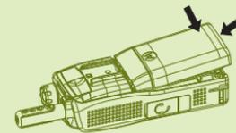
보호 흰색 상자에서 배터리를 분리합니다. 그림과 같이 배터리 위쪽을 배터리 장착부에 삽입합니다. 찰칵 소리가 날 때까지 배터리 아래쪽을 조심스럽게 누릅니다.
