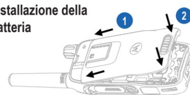
1. Inserire la batteria nel vano inclinandola.
