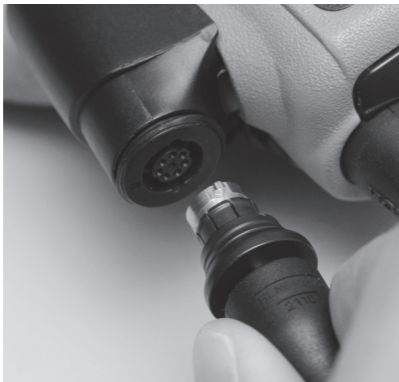
Рис. 1. Чтобы подключить аксессуар, возьмитесь за нижнюю часть разъема, совместите его с гнездом и вставьте.
