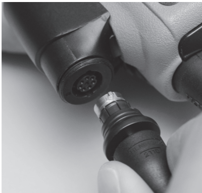
Figura 1. Para inserir o acessório, pegar na base do conector, alinhar e pressionar.
