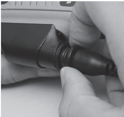
Figure 2. Pour débrancher l'accessoire, tenez le connecteur par le bas, tirez en respectant l'alignement.
