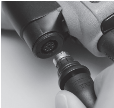
Abb. 1. Halten Sie zum Anschließen des Zubehörs den Stecker an seinem Unterteil fest und stecken Sie ihn in die Buchse.
