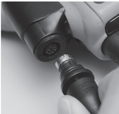
Figura 1. Per inserire l'accessorio, tenere il connettore dal lato inferiore, allineare e spingere.
