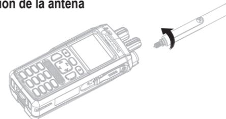
Apague el radio antes de conectar la antena. Alinee la parte inferior de la antena y la base atornillada en la parte superior del radio. Gire hacia la derecha hasta apretar. No la fuerce.
