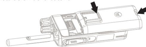
Inserte la batería en el compartimento. Deslícela hacia la parte superior del radio hasta que encaje en su lugar.
