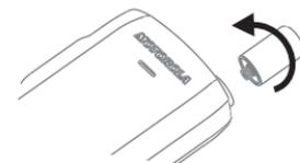
アンテナを取り付ける前に、無線機の電源をお切りください。アンテナの下部を無線機の上部のネジ込みベースに合わせます。時計回りの方向にしっかりと回します。力を入れすぎないようにしてください。
