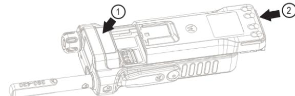
La batterie doit être installée uniquement dans une zone sans danger. Retirez la batterie de son étui protecteur. Ajustez l'étiquette personnalisable (1). Insérez la batterie dans le logement (2). Faites glisser délicatement la batterie vers le haut de la radio jusqu'à ce qu'elle s'enclenche en place.
