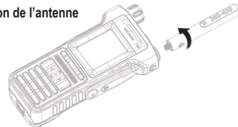
Mettez la radio hors tension avant d'installer l'antenne. Alignez le bas de l'antenne et le socle à visser avec le dessus de la radio. Tournez dans le sens horaire jusqu'à l'enclenchement. Ne forcez pas.
