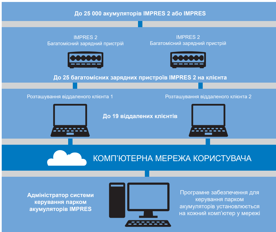
Рисунок 23. Керування акумуляторами IMPRES за допомогою мережевих зарядних пристроїв
