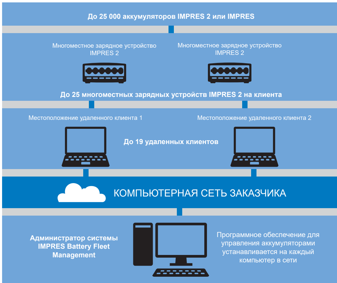
Рис. 23. Управление аккумуляторами IMPRES через сетевые зарядные устройства
