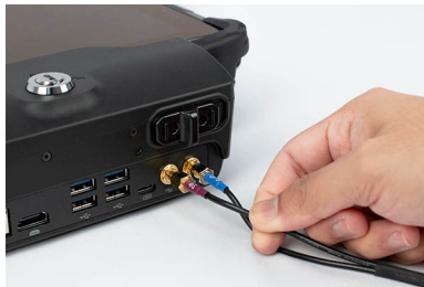
Figure 10 : Connecteur 4G sur la station d'accueil de tablette VLS
