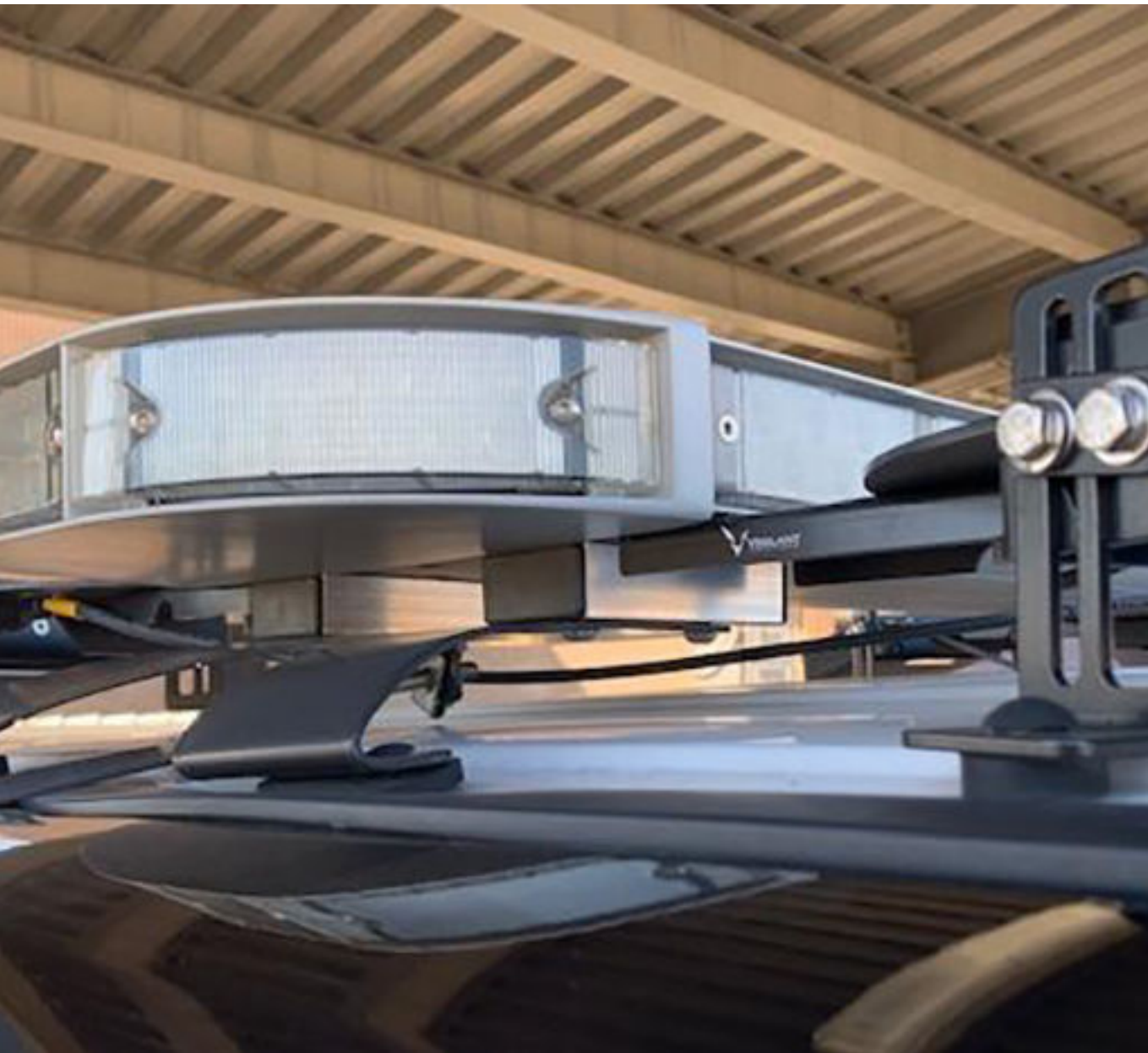
Installation d'une barre de lumière Whelen avec des entretoises sur mesure
