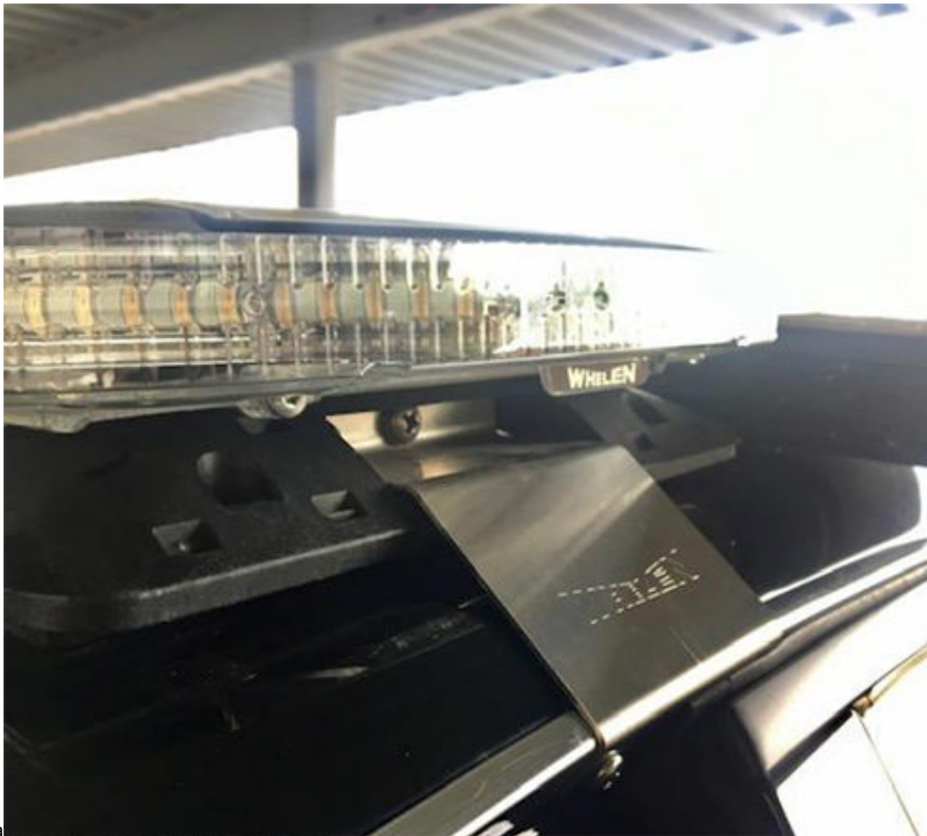
Installation des entretoises sur mesure
