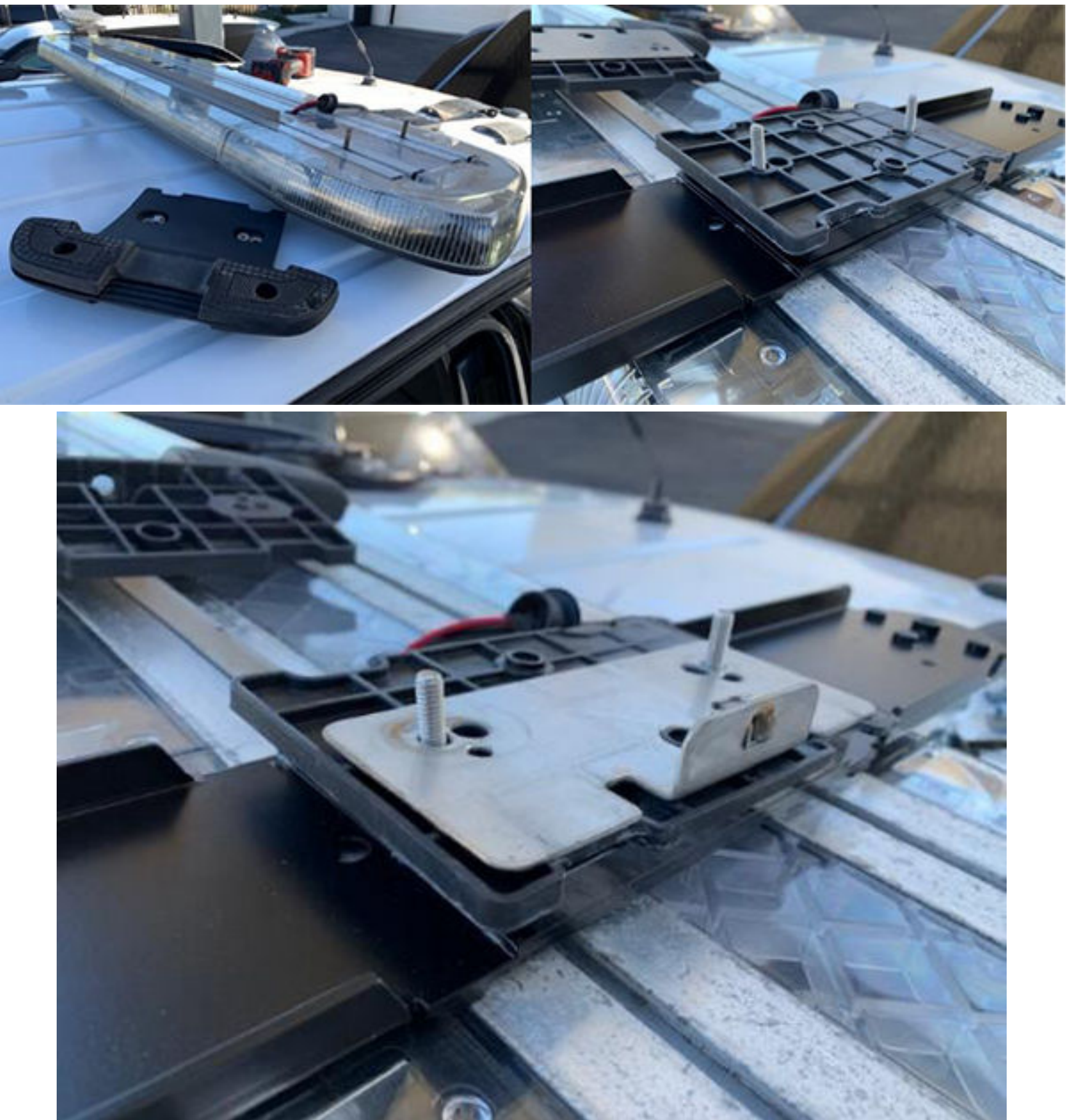
Figure 29 : Processus d'installation du support de barre de lumière SoundOff
