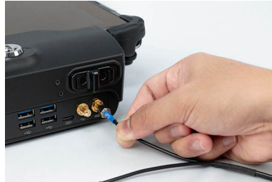
Figura 10: Conexión del conector 4G a la estación de acoplamiento de la tableta VLS
