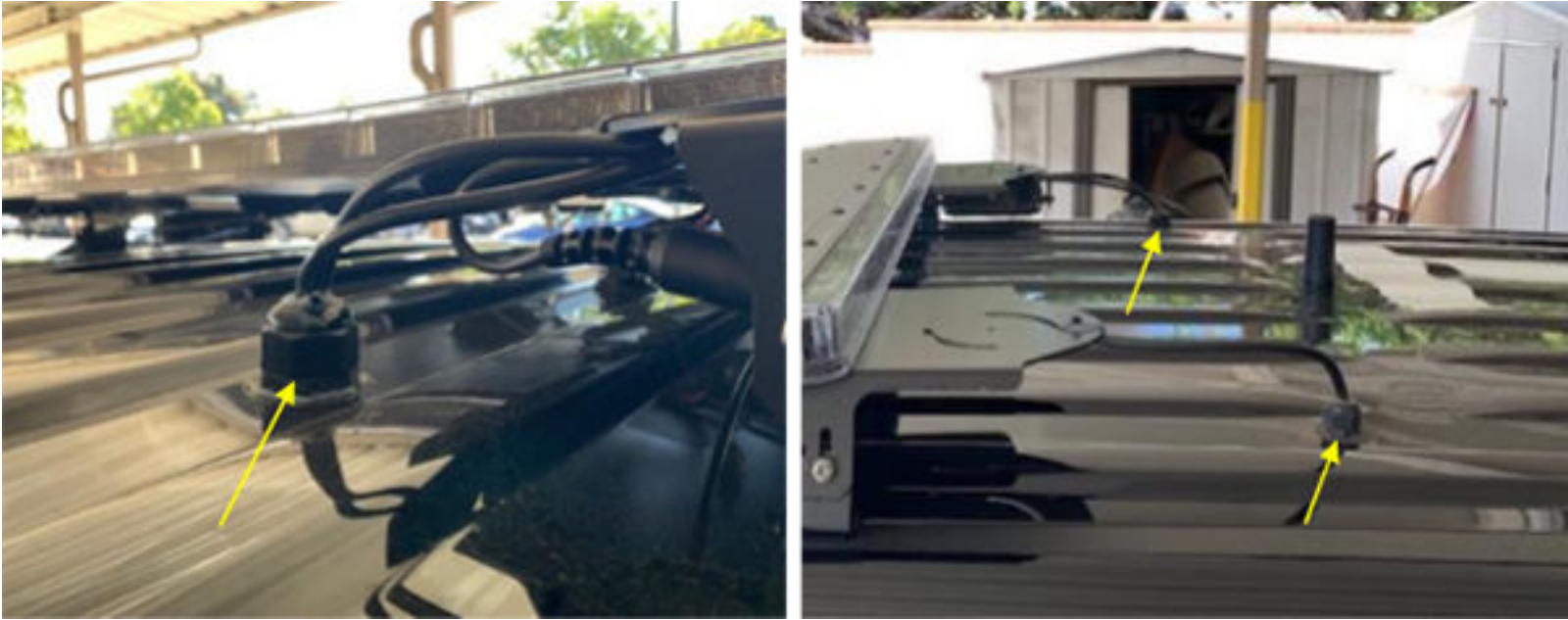
Figura 16: Colocación de los cables a través de los orificios del techo
