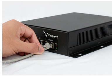
Figura 7: Conexión del cable Ethernet al inyector PoE
