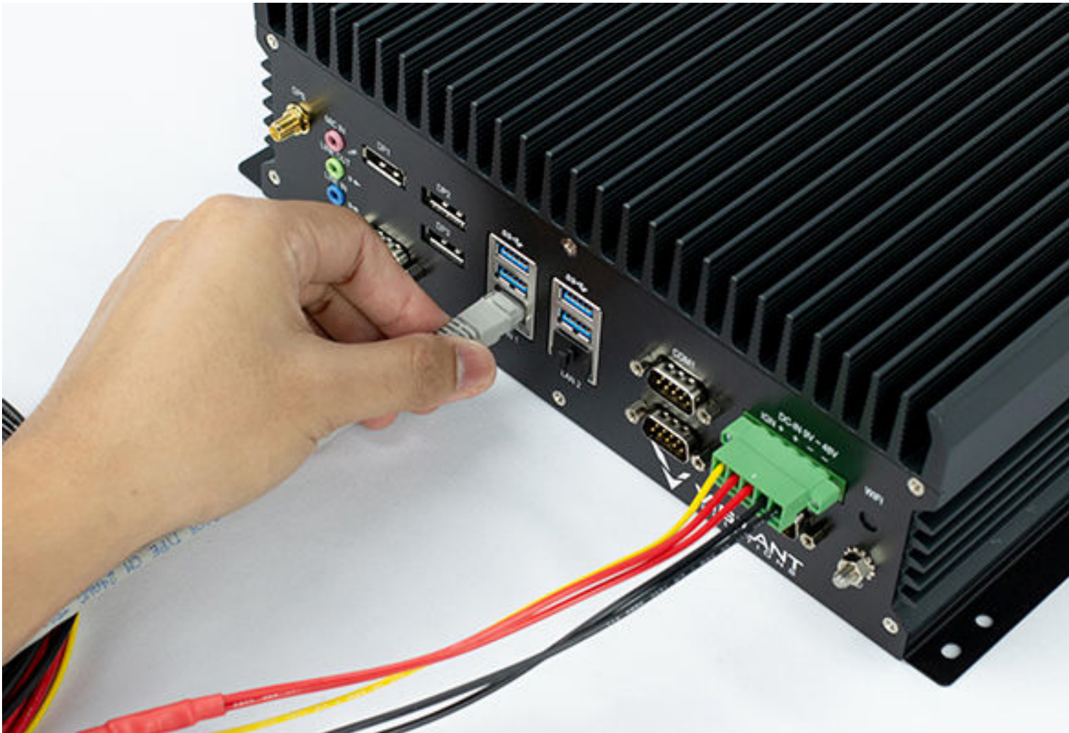
Figure 3 : Câble Ethernet sur le boîtier VLP
