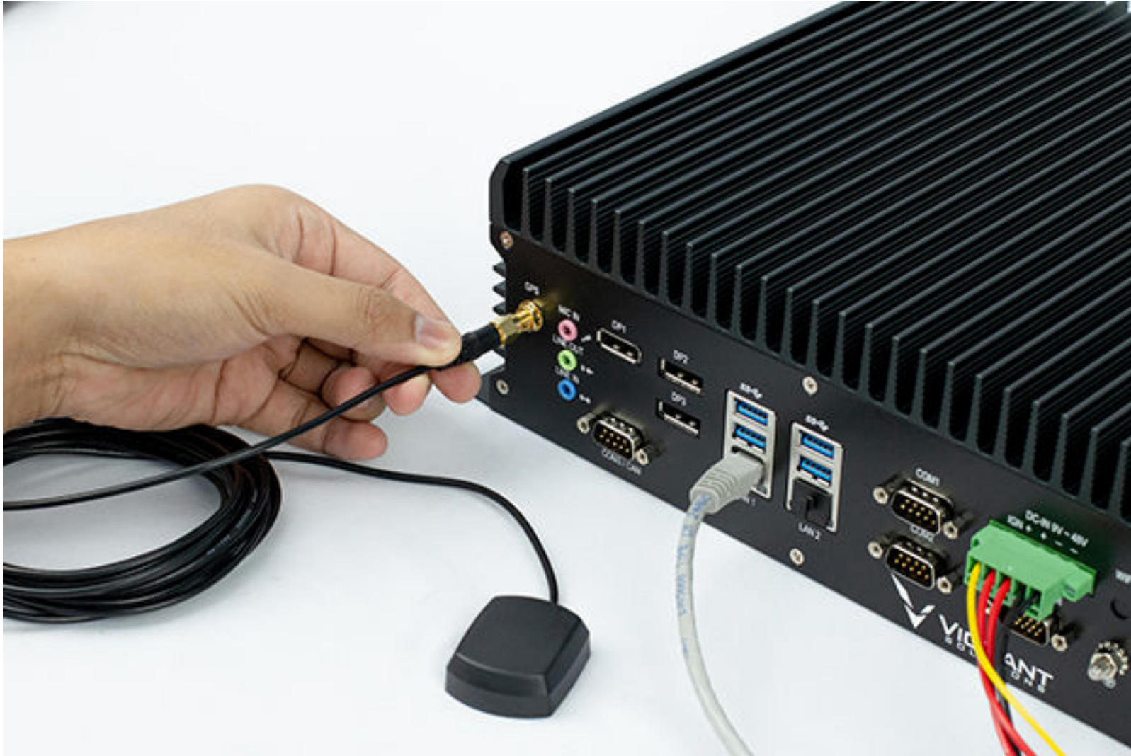
Figure 5 : Câble GPS sur le processeur VLP
