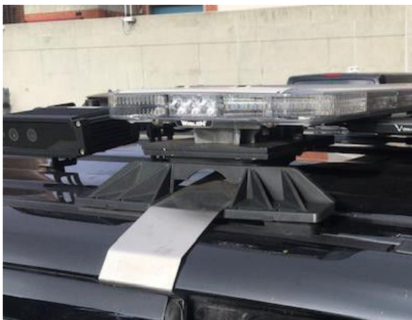
Instalação do Code 3 com espaçadores fornecidos
