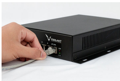
Figura 30: Conexión del cable Ethernet al inyector PoE
