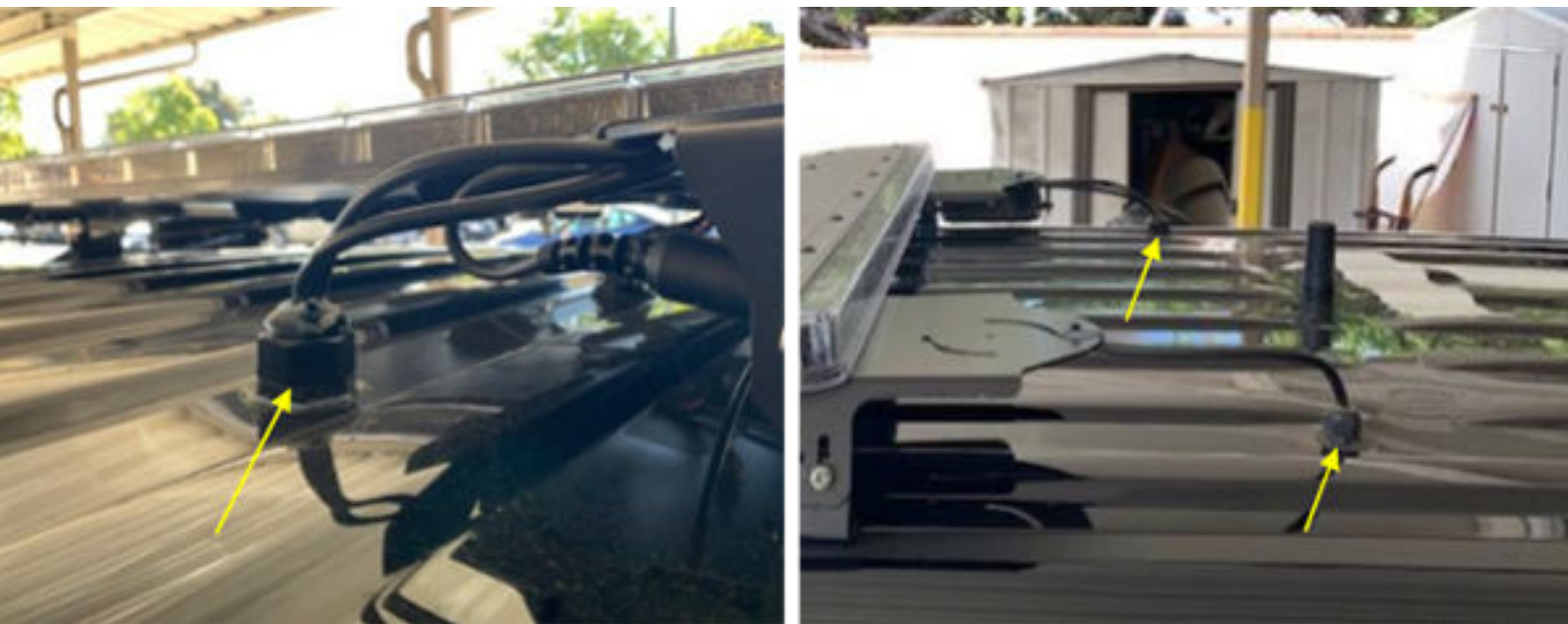
Figura 16: Passagem de cabos pelos furos do telhado
