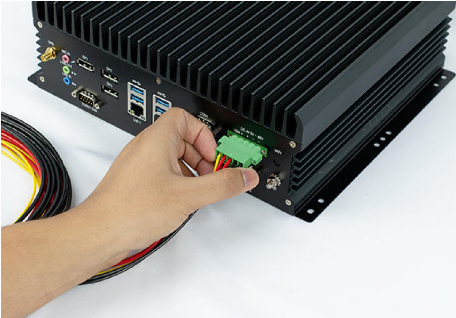
Figura 2: Chicote de fiação para a caixa do VLP
