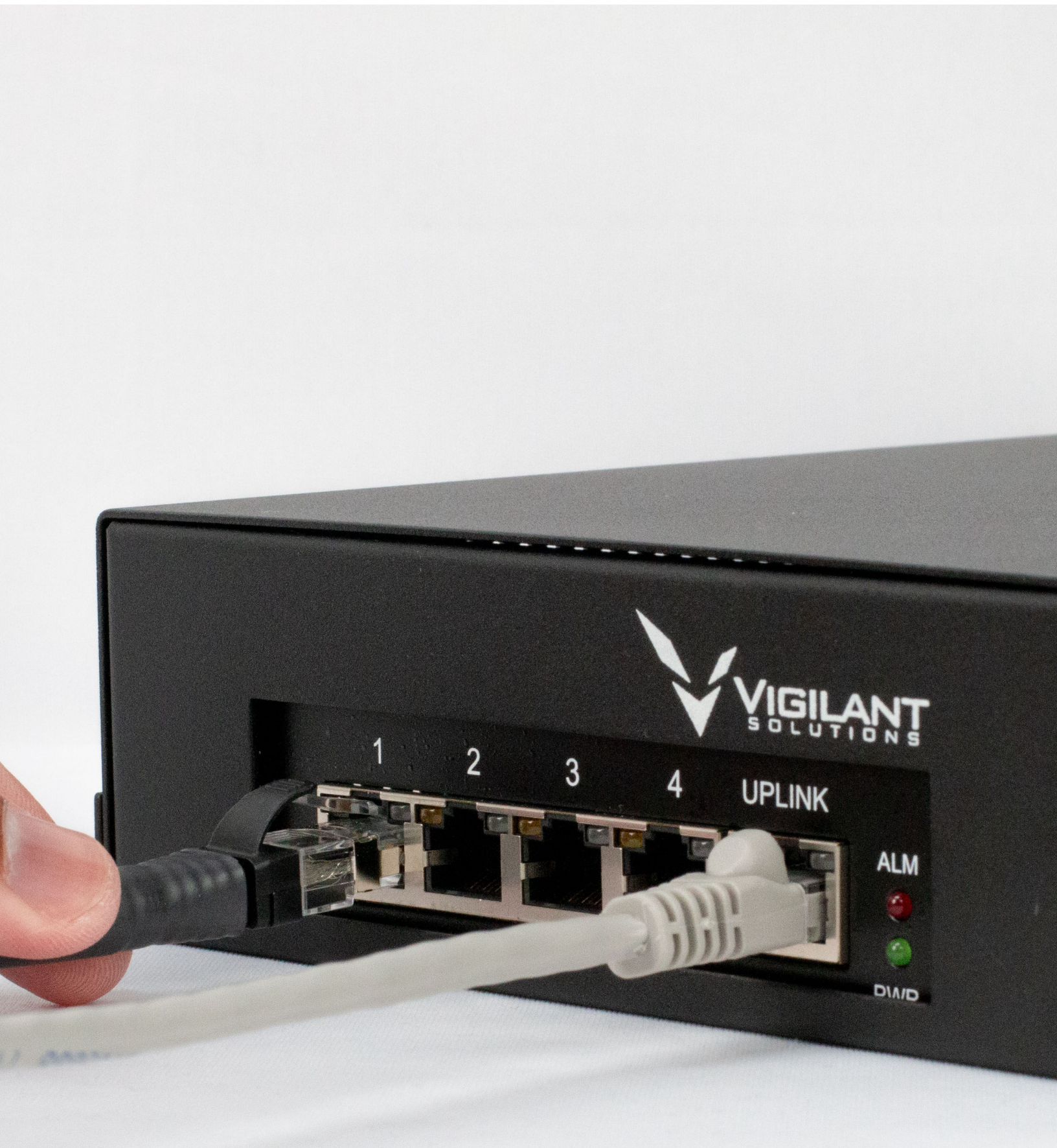
Figura 8: Cabo da câmera para o injetor PoE
