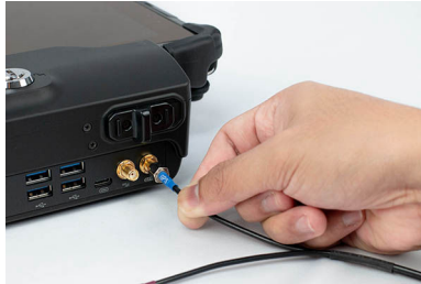
Figure 33 : Connecteur 4G sur la station d'accueil de tablette VLS
