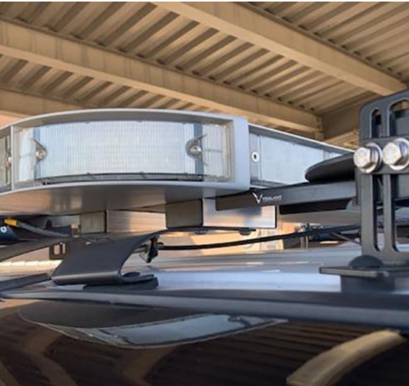
Instalación de Whelen con espaciadores personalizados
