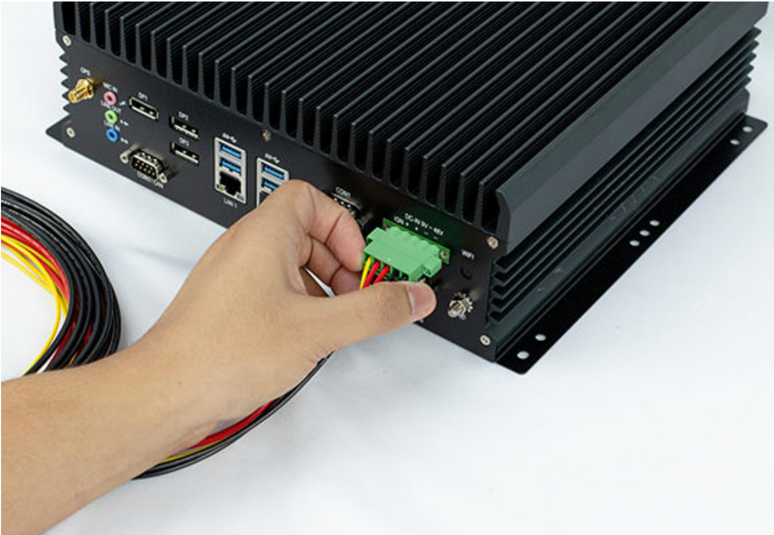
Figure 2 : Faisceau de câblage sur le boîtier VLP
