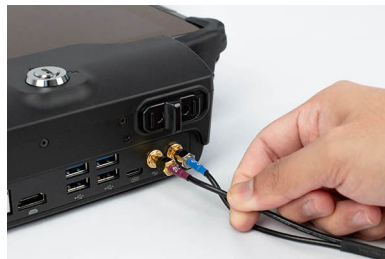
Figura 33: Conexión del conector 4G a la estación de acoplamiento de la tableta VLS
