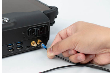
Figura 33: Conector 4G para estação de acoplamento do tablet VLS
