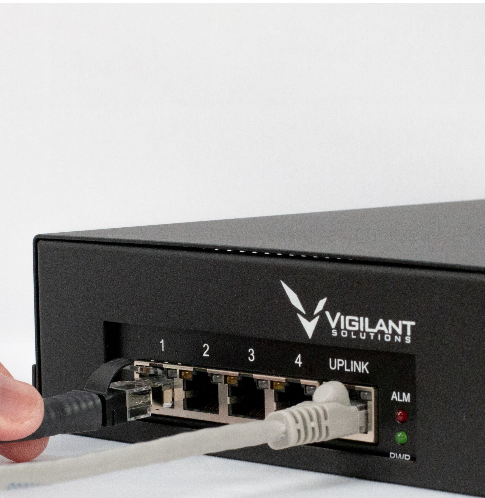
Figure 8 : Câble de caméra à injecteur PoE
