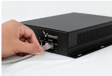
Figure 7 : Câble Ethernet à injecteur PoE
