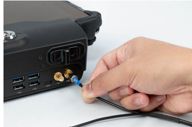
Figura 33: Conexión del conector 4G a la estación de acoplamiento de la tableta VLS
