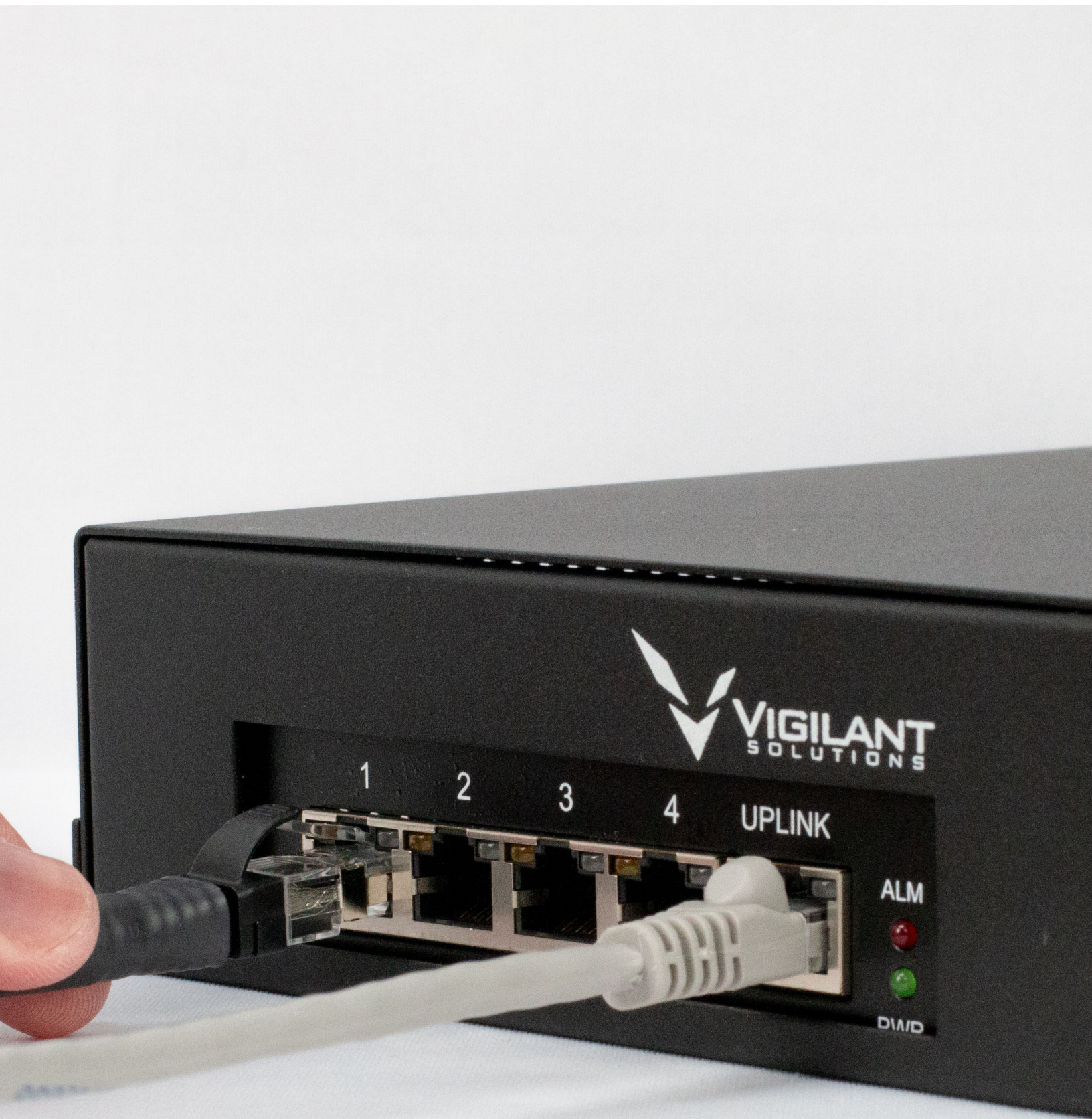
Figura 31: Conexión del cable de la cámara al inyector PoE
