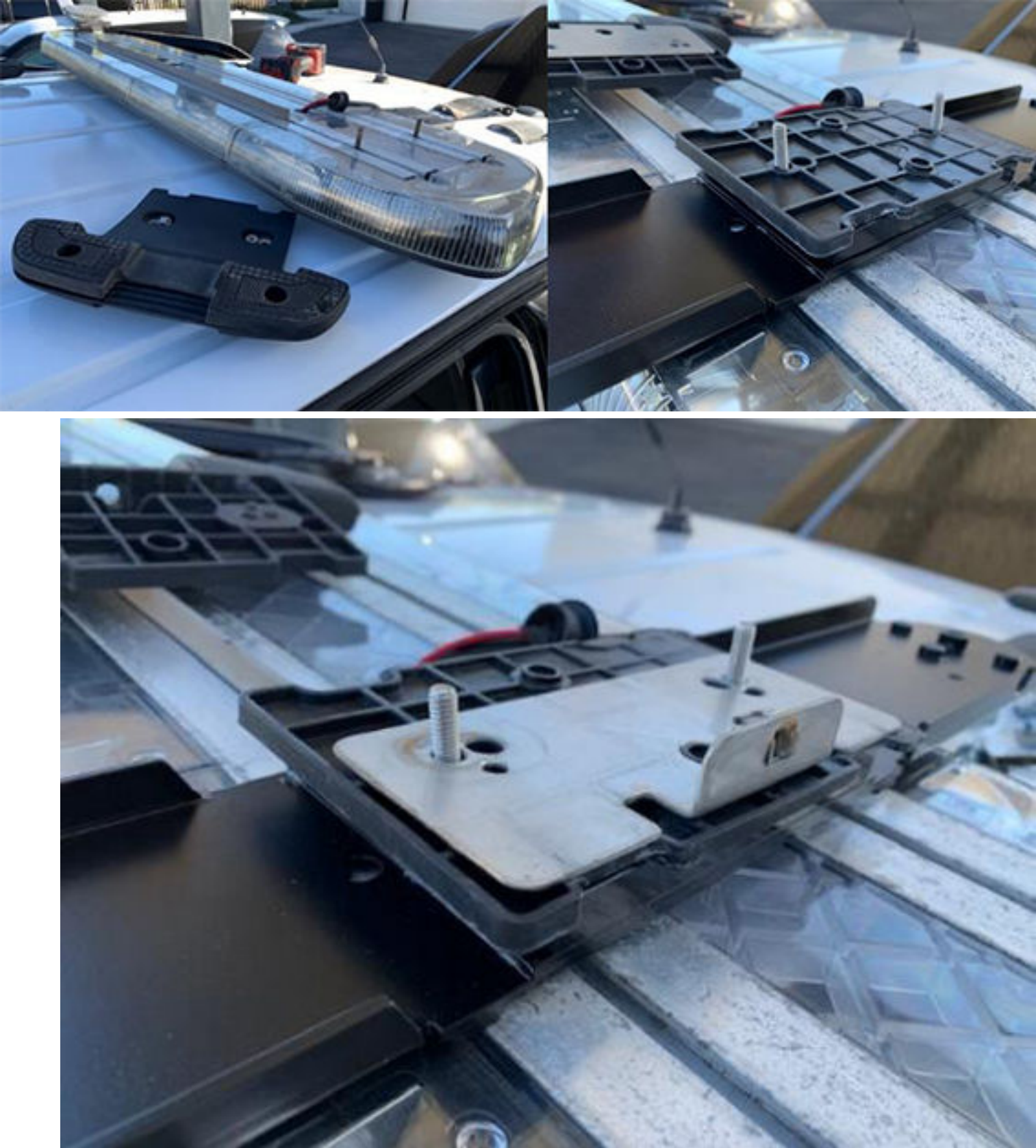
Figura 29: Proceso de instalación de SoundOff
