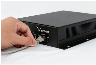
Figura 7: Cabo Ethernet para injetor PoE
