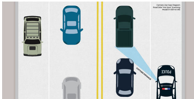
Figura 22: Distancia de captura de carril adyacente de tráfico
