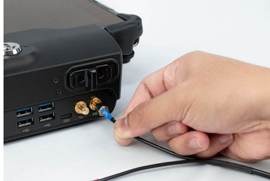
Figure 10 : Connecteur 4G sur la station d'accueil de tablette VLS
