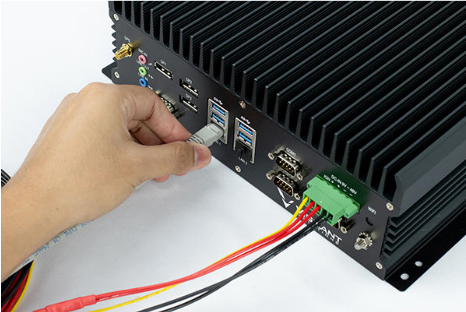
Figure 3 : Câble Ethernet sur le boîtier VLP
