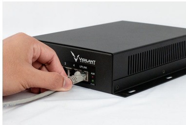
Figure 30 : Câble Ethernet sur l'injecteur PoE
