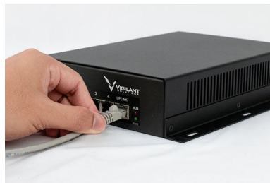
Figura 30: Cabo Ethernet para injetor PoE
