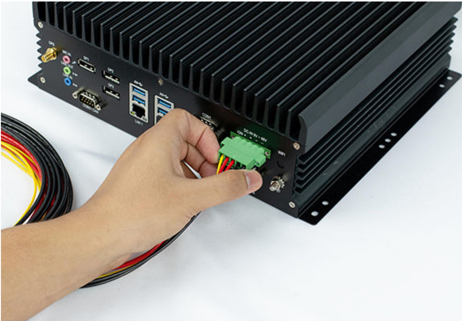
Figure 2 : Faisceau de câblage sur le boîtier VLP
