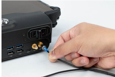
Figura 10: Conector 4G para estação de acoplamento do tablet VLS
