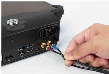
Figura 10: Conector 4G para estação de acoplamento do tablet VLS
