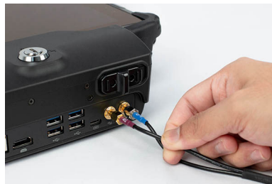
Figura 10: Conexión del conector 4G a la estación de acoplamiento de la tableta VLS
