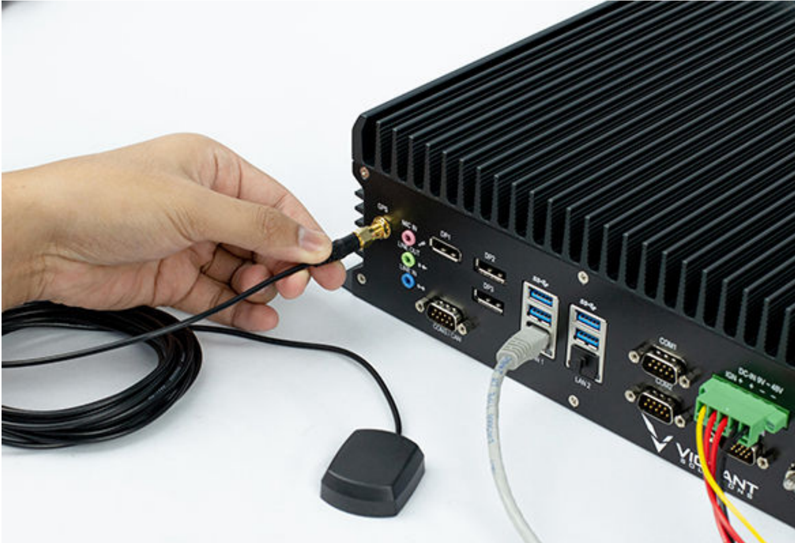
Figure 5 : Câble GPS sur le processeur VLP
