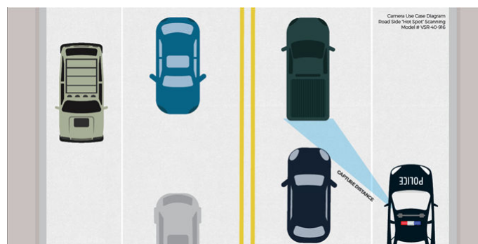
Figura 22: Distância de captura da faixa adjacente no tráfego
