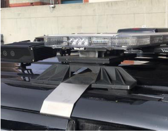
Instalación de Code 3 con los espaciadores proporcionados
