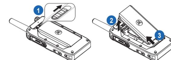
1. Faites glisser le loquet de la batterie vers la droite et maintenez-le jusqu'à ce que vous puissiez retirer la batterie.
