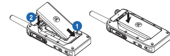
1. Insérez la batterie dans le compartiment jusqu'à ce que les contacts soient alignés et que les crochets de la batterie s'enclenchent.
