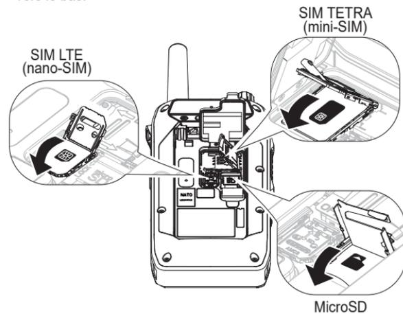
5. Fermez le support de la carte MicroSD/SIM TETRA/SIM LTE et faites-le glisser en position de verrouillage.
