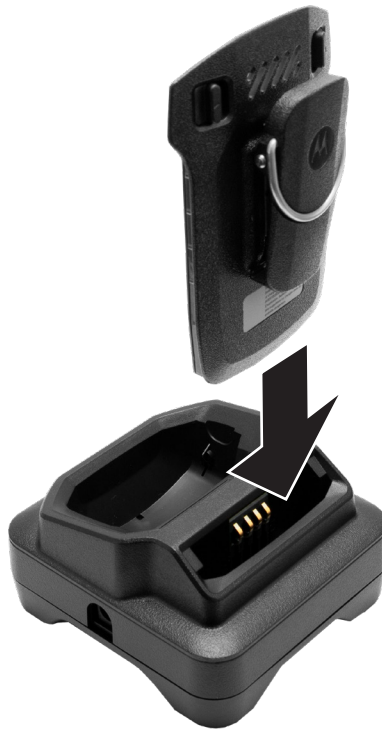
Figure 7 : Charge d'un appareil avec sa batterie
