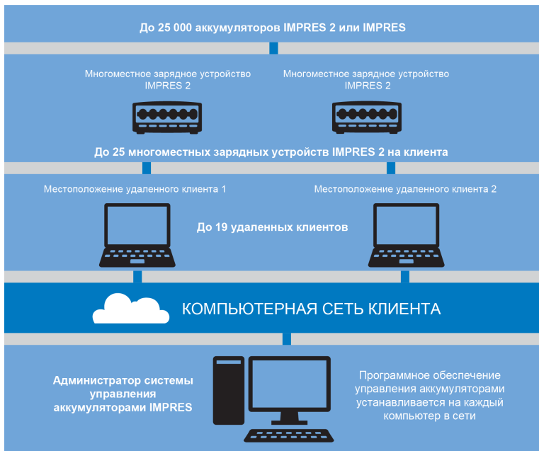
Рис. 28. Управление группами аккумуляторов IMPRES через сетевые зарядные устройства
