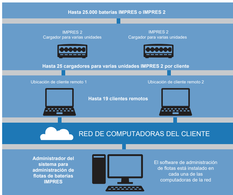
Figura 28: IMPRES Battery Fleet Management a través de cargadores de red
