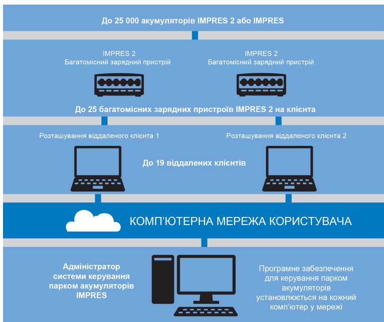
Рис. 28: Керування акумуляторами IMPRES за допомогою мережі зарядних пристроїв
