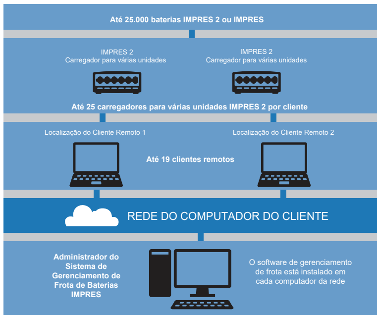
Figura 28: Gerenciamento de Frota de Bateria IMPRES por Carregadores de Rede
