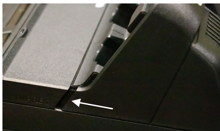
Figura 31: Reinstalação da tampa superior
