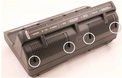
Figura 32: Instalação dos parafusos da tampa superior
