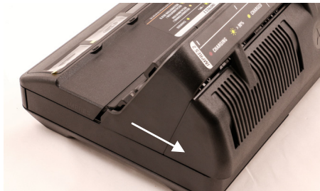
Figura 25: Remoção da tampa superior
