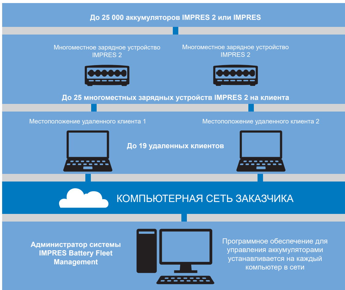
Рис. 28. Управление аккумуляторами IMPRES через сетевые зарядные устройства
