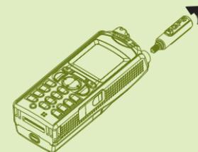
Spegnere il terminale prima di collegarvi l'antenna. Allineare la parte inferiore dell'antenna all'apposito vano sulla parte superiore del terminale. Ruotare in senso orario finché l'antenna non è fissata. Non esercitare forza eccessiva.
