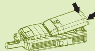
Rimuovere la batteria dalla custodia protettiva in carta bianca. Inserire la parte superiore della batteria nel vano, come illustrato nella figura. Premere delicatamente la parte inferiore della batteria finché non scatta in posizione.
