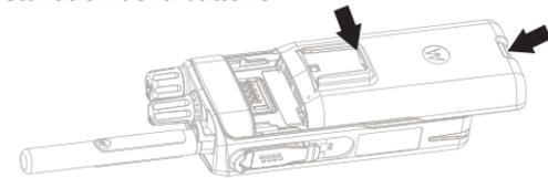
Insérez la batterie dans le compartiment.
