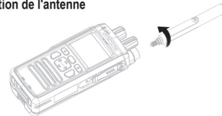
Mettez la radio hors tension avant de fixer l'antenne.
