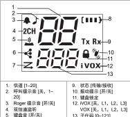
注意: 按下最后一个按键后,对讲机屏幕将变暗 5 秒。出于节省 电池电量的目的, LED 指示灯将闪烁且再过 5 秒后对讲机 屏幕将关闭。按下任何按键(手电筒按键除外)可恢复显 示屏。
