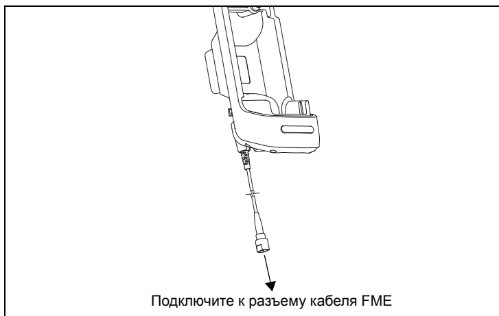
Рис. 6: Подсоединение радиокабеля от базовой станции к разъему кабеля FME
