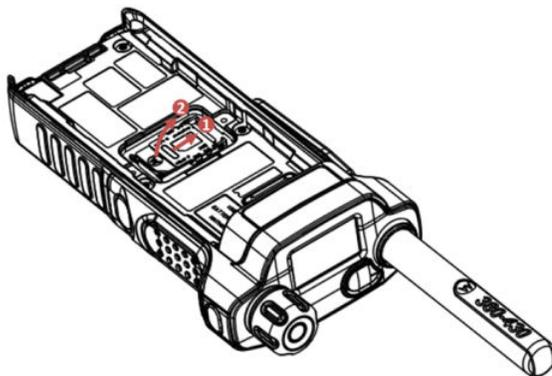
5. Schieben Sie die Dummy-SIM-Karte in die in der folgenden Abbildung gezeigte Richtung, um sie aus der SIM-Kartenhalterung zu entfernen.
