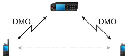
Wenn sich das Funkgerät im DMO-Repeater-Modus befindet, verlängert es den DMO-Bereich durch eine Weitersendung der erhaltenen Informationen von einem Funkgerät zu einem anderen. Er überträgt Gruppenrufe, Einzelrufe und Daten auf einer bestimmten Frequenz. Im Diagramm dient das Funkgerät in der Mitte als Repeater.
