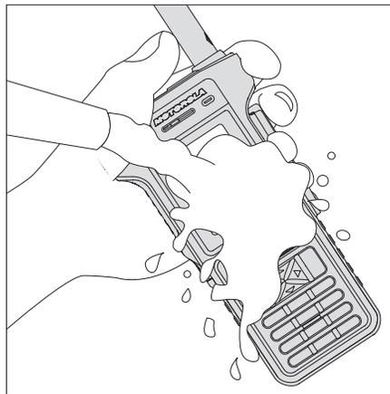
7. Schütteln Sie überschüssiges Wasser ab, und trocknen Sie das Funkgerät mit einem Handtuch. Achten Sie besonders darauf, das Wasser aus den Ritzen des Funkgeräts zu entfernen.
