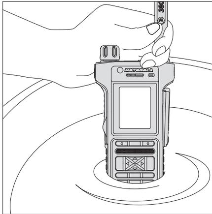
2. Ziehen Sie das Funkgerät aus dem Wasser, und schalten Sie den Encoder-Knopf jeweils zweimal um 360° im Uhrzeigersinn und um 360° gegen den Uhrzeigersinn.
