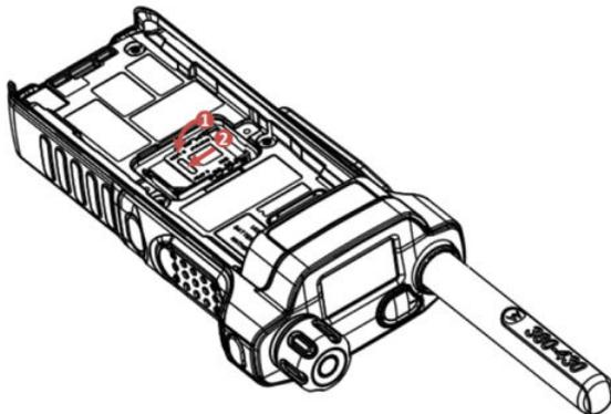
8. Prüfen Sie visuell den O-Ring der SIM-Karten-Abdeckung, bevor Sie die SIM-Karten-Abdeckung in das Chassis einführen.
