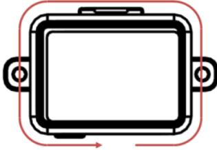
10. Zur korrekten Positionierung der SIM-Karten-Abdeckung richten Sie die SIM-Karten-Abdeckung am Chassis aus (siehe folgende Abbildung). Setzen Sie die SIM-Karten-Abdeckung vorsichtig in die Öffnung an der Rückseite des Chassis, und achten Sie dabei darauf, dass der O-Ring der SIM-Karten-Abdeckung nicht von der Abdeckung gequetscht wird (bei eingesetzter Abdeckung darf der Ring nicht sichtbar sein).
