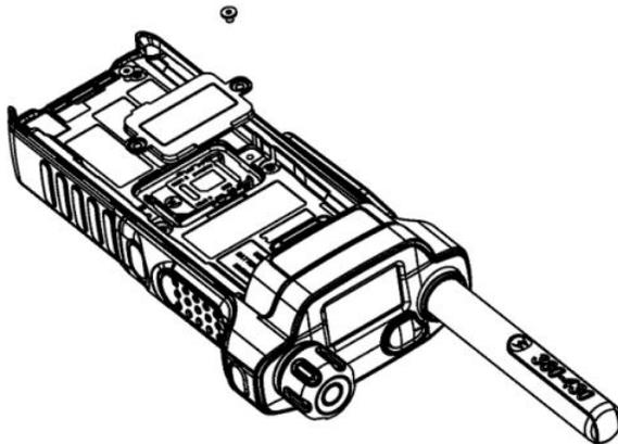
4. Schieben Sie den SIM-Kartenhalter in Richtung Abdeckung des Funkgeräts (Richtung des Pfeils ENTSPERREN), um ihn zu entsperren und abzuheben.
