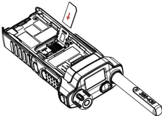
7. Schließen Sie den SIM-Kartenhalter, und schieben Sie den Halter in Richtung der PTT-Seite des Funkgeräts (Richtung des Pfeils SPERREN), um ihn zu sperren.
