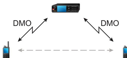
Wenn Ihr Funkgerät ein potenzielles Repeater-Signal erkennt oder eine Verbindung zu einem Repeater aufbaut, dann spielt es einen Ton ab und zeigt die Nachricht `Repeater nutzbar` sowie ein entsprechendes
