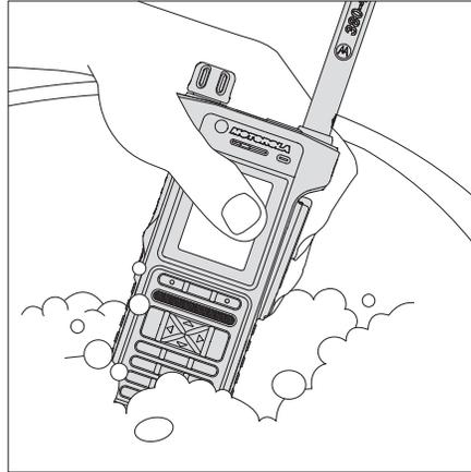
4. Reiben Sie die Kunststoffoberflächen des Geräts (vorne, hinten, unten, oben und seitlichen Bereich) vorsichtig mit einem weichen Baumwolltuch ab. Lassen Sie an der Lautsprecherabdeckung, dem Ohrhörer und der oberen und unteren Mikrofonanschlussöffnung besondere Vorsicht walten.
