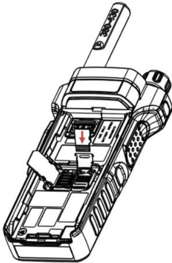
6. Schließen Sie den microSD-Kartenhalter, und schieben Sie den Halter in Richtung der Unterseite des Funkgeräts (Richtung des Pfeils SPERREN), um ihn zu sperren.
