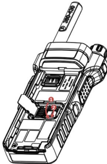
7. Schließen Sie den SIM-Kartenhalter, und schieben Sie den Halter in Richtung der PTT-Seite des Funkgeräts (Richtung des Pfeils SPERREN), um ihn zu sperren.
