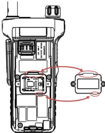
11. Üben Sie etwas Druck auf die SIM-Karten-Abdeckung aus, und ziehen Sie mithilfe des T-5IP-TORX-PLUS-Schraubenziehers die Schrauben der SIM-Karten-Abdeckung mit einem Drehmoment von 0,18 bis 0,22 Nm (1,6 bis 2,0 lbf In) an.
