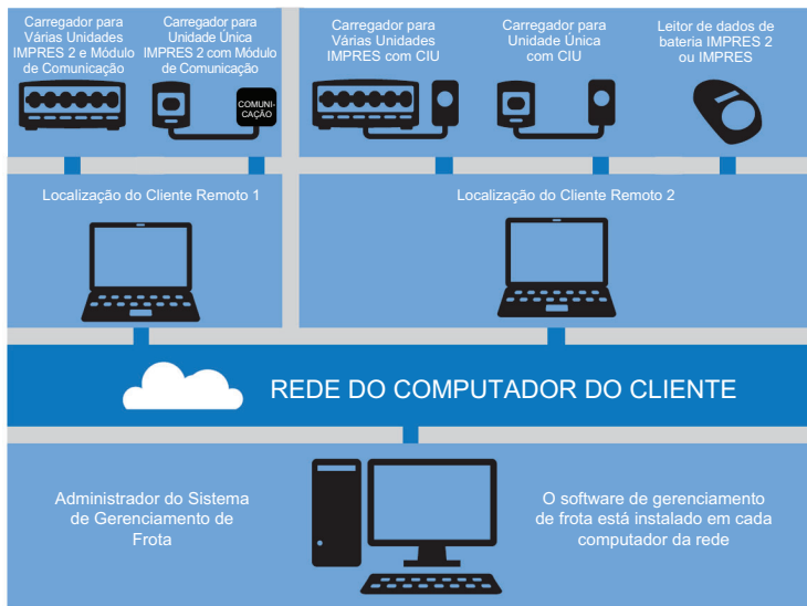
Figura 2: Gerenciamento de Bateria IMPRES via rede de carregadores
