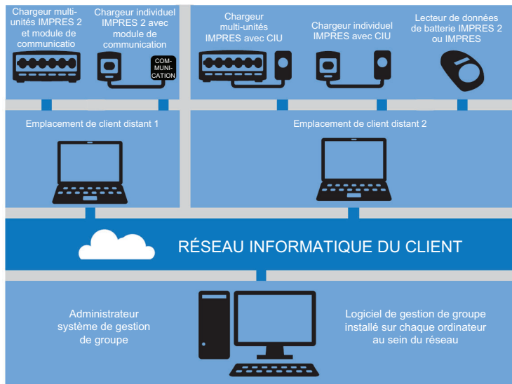
Figure 2 : Gestion de batterie IMPRES par des chargeurs réseau
