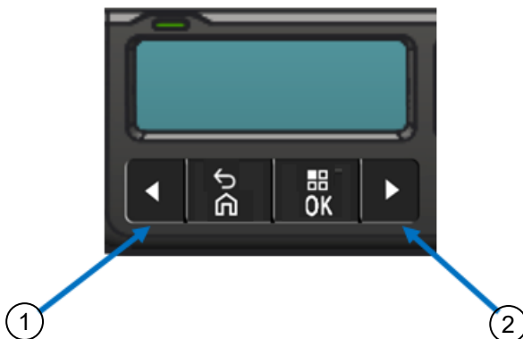
Figura 4: Botones de pantalla de menú para acceder al modo de configuración
