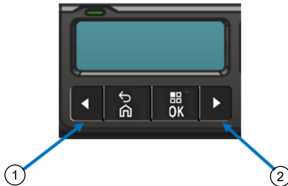
Afbeelding 4: Weergaveknoppen voor openen Setup-menu
