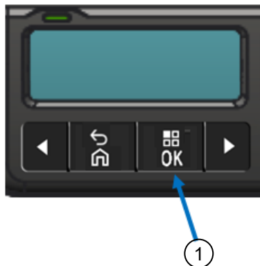
Kuva 14: Valikkonäytön painike Analysaattoritilaan siirtymiseen
