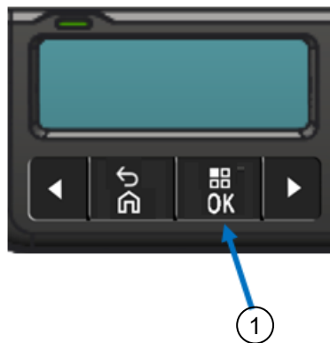
Figure 14 : Bouton de l'écran pour accéder au mode Analyseur
