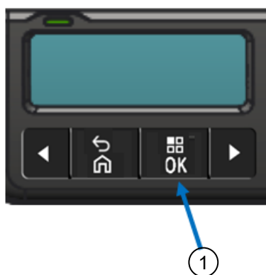
Afbeelding 14: Menuknoppen voor openen van analysemodus
