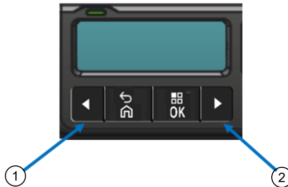
Figur 4: Knapper i menyvisningen for å gå inn i Setup Mode
