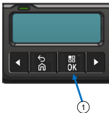
Figura 14: Botón de pantalla de menú para ingresar al modo de analizador
