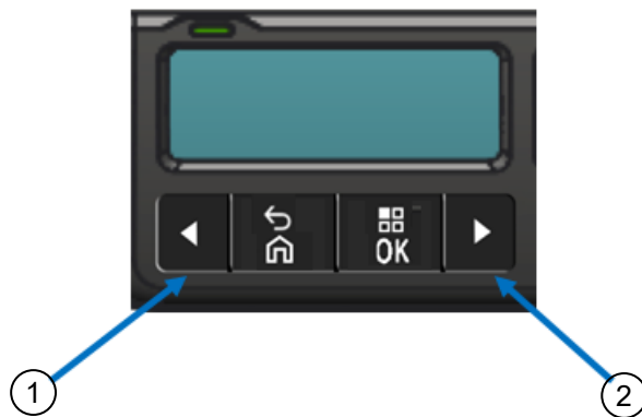
Рис. 4. Кнопки отображения меню для перехода в режим настройки
