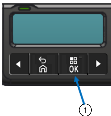
Figura 14: Botão do menu no ecrã para aceder ao modo de analisador
