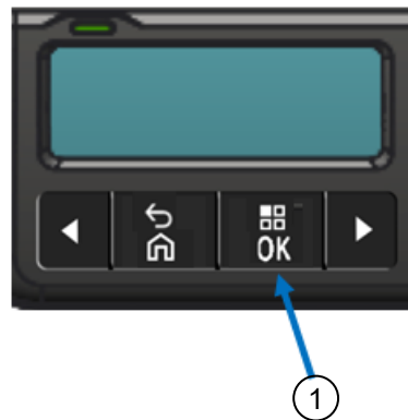
Figur 14: Knapp i menyvisningen for å gå inn i analysemodus
