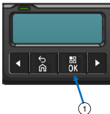
Figur 14: Menudisplayknappen for adgang til Analysetilstand
