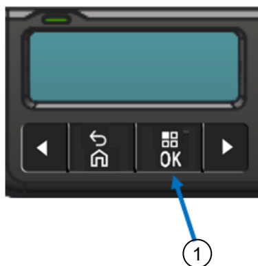
Figură 14: Butonul de afișare a meniului pentru accesarea Analyzer Mode
