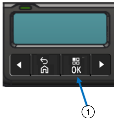
Рисунок 14. Кнопка меню дисплея для входу в режим аналізу
