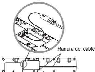
Figura 6: Inserción del cable de alimentación de CA en el enchufe de CA
