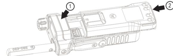
A instalação da bateria deve ser feita apenas em áreas seguras. Remova a bateria de seu estojo de proteção. Encaixe a etiqueta personalizável (1). Insira a bateria no compartimento (2). Deslize cuidadosamente a bateria em direção à parte superior do rádio até que ela se encaixe.
