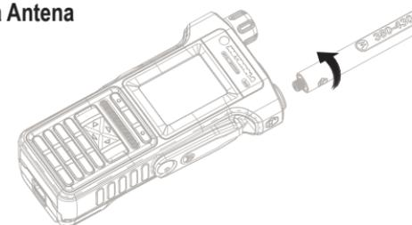
Desligue o rádio antes de anexar a antena. Alinhe a parte inferior da antena e a base de rosca na parte superior do rádio. Gire-a no sentido horário até obter o encaixe perfeito. Não forçar.
