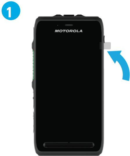
1. Remova a película de proteção da tela do dispositivo.
