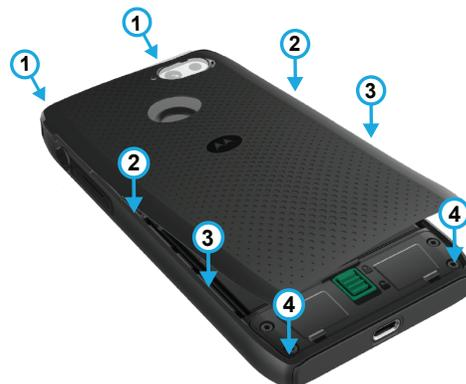
1. Coloque a tampa da bateria na parte traseira do dispositivo na ordem mostrada na imagem.
