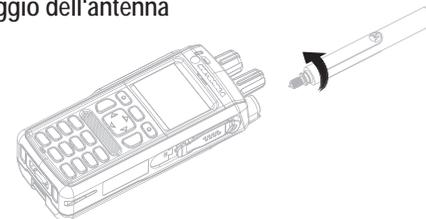
Spegnere la radio prima di fissare l'antenna.
