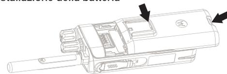
Inserire la batteria nel vano.
