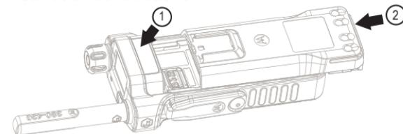
L'installation de la batterie doit uniquement se faire dans des zones non dangereuses. Sortez la batterie de son étui de protection. Installez l'étiquette personnalisable (1). Insérez la batterie dans le compartiment (2). Faites glisser avec précaution la batterie vers le haut de la radio jusqu'à ce que vous entendiez un clic.
