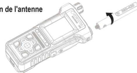
Mettez la radio hors tension avant de fixer l'antenne. Alignez le bas de l'antenne et sa base à visser sur le dessus de la radio. Vissez l'antenne (dans le sens horaire) jusqu'à ce qu'elle se bloque. Ne forcez jamais.
