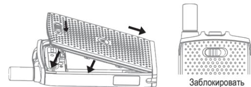
**Установка:** вставьте нижние зажимы крышки аккумулятора в слот. Нажмите на верхнюю часть крышки аккумулятора, а затем на ее среднюю часть. Сдвиньте фиксатор влево, чтобы заблокировать крышку.
