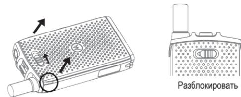
**Снятие:** сдвиньте фиксатор вправо, чтобы разблокировать крышку. Поднимите крышку отсека аккумулятора.
