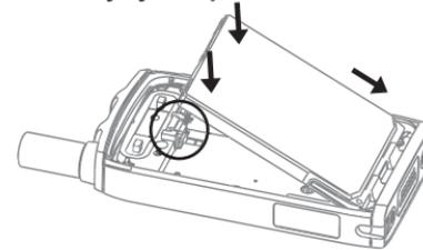
Вставьте нижнюю часть аккумулятора в отсек. Опустите верхнюю часть аккумулятора в отсек и нажмите до щелчка фиксатора отсека внутреннего аккумулятора.
