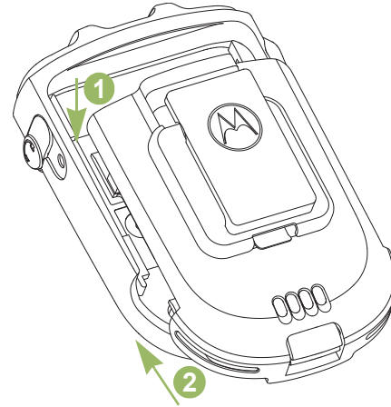
Afbeelding 2.2: De batterij in de WRSM plaatsen
