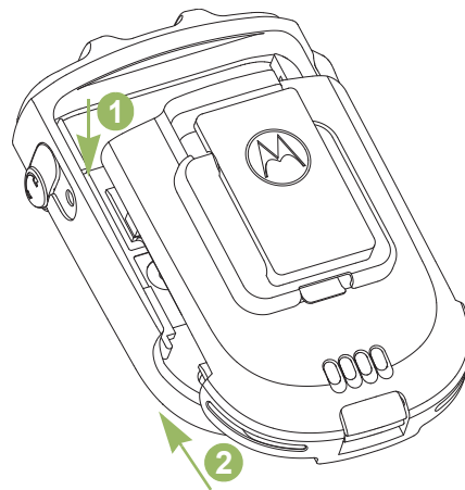
Figure 2.2 : placement de la batterie dans le micro haut-parleur déporté sans fil
