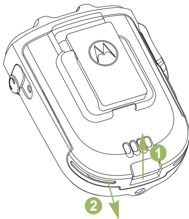
Figure 2.3 : retrait de la batterie du micro haut-parleur déporté sans fil
