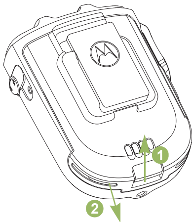
Figure 2.3 : Retrait de la batterie du WRSM
