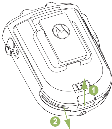
Рис. 2.3. Від'єднання батареї від WRSM
