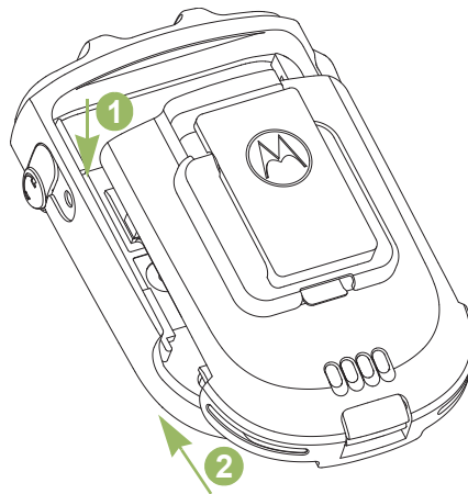
Figura 2.2: Colocación de la batería en el WRSM
