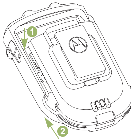
Figura 2.2: Encaixe da bateria no WRSM
