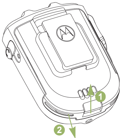
Figura 2.3: Remoção da bateria do WRSM
