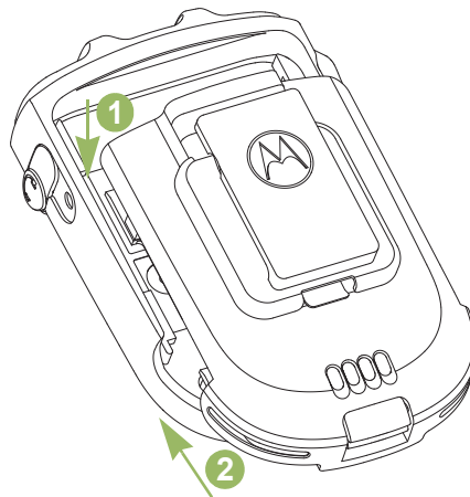
Рис. 2.2. Встановлення батареї в WRSM
