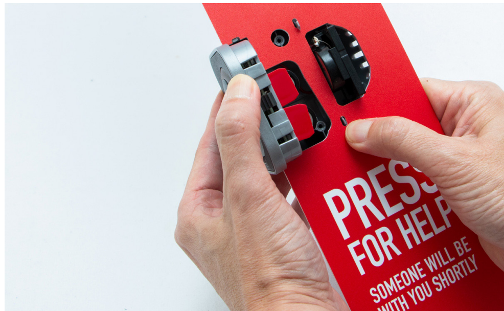
Figure 10 : Insertion du crochet inférieur
