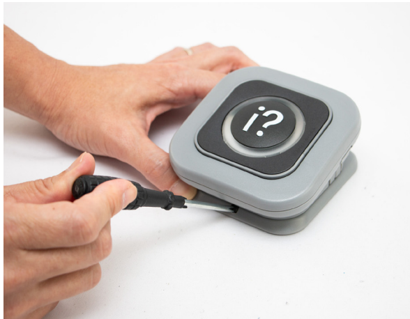
Figura 21: Desmontar a placa de montagem da base do botão de chamada
