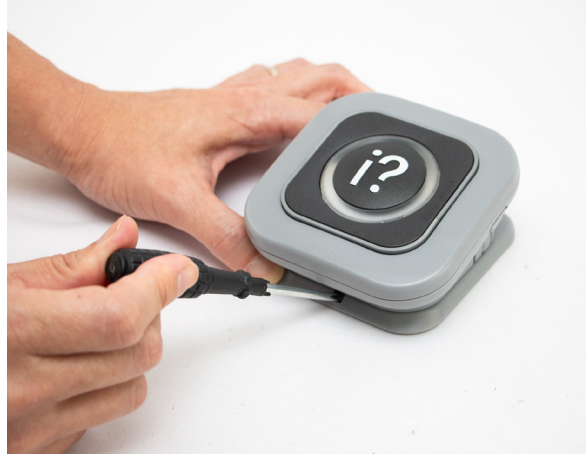
Figure 25 : Démontez la plaque de montage de la base du bouton d'appel
