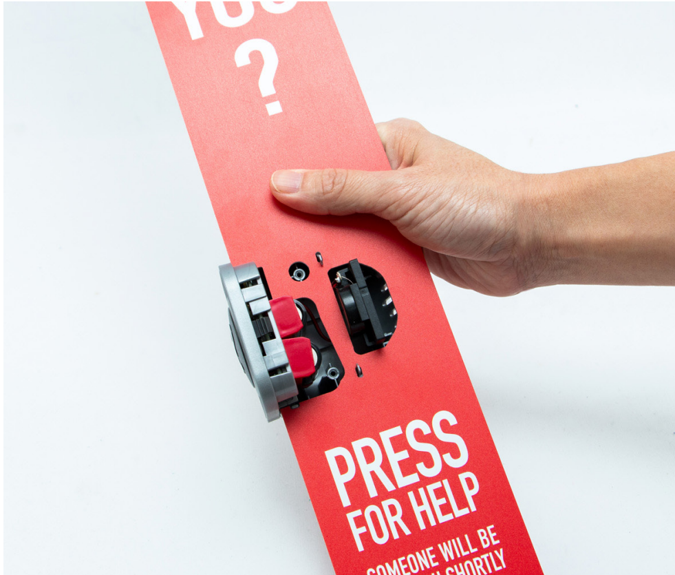
Figura 9: Inserción del gancho superior
