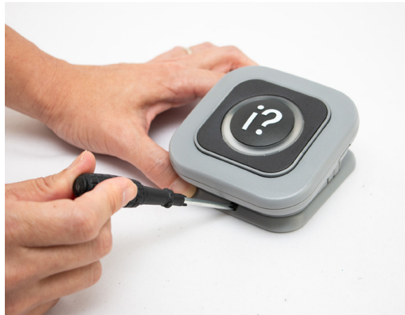
Figura 25: Desmontar a placa de montagem da base do botão de chamada
