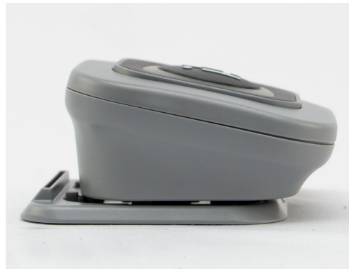
Figura 26: Remover a base do botão de chamada
