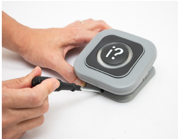
Figura 21: Desmonte la placa de montaje de la base del botón de llamada
