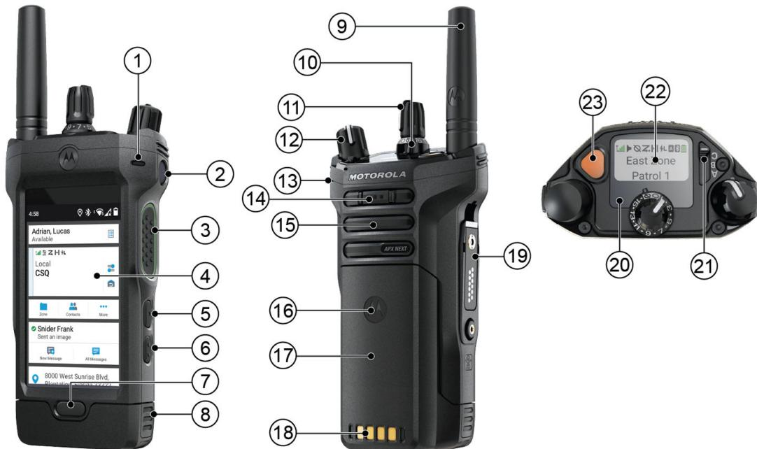
**Figura 2: Visão geral do APX NEXT XE**
